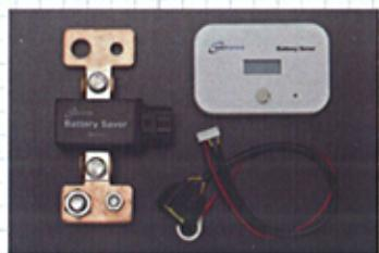
サブバッテリーの電圧を常時監視する「Battery Saver」システム。規定電圧を下回るリレーでバッテリーとインバーターなどの機器との接続を遮断する。
