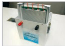
SimpleBMSはバッテリー充電時の過度なばらつきを防止するための制御基板です。充電時に各セルの電圧を監視し、セル電圧が3.7V以上になった際に熱として放電し、セル間のばらつき及び通常使用における過充電を防止します。※1
