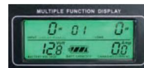
大型液晶画面にデータ表示 (バックライト機能付き)
