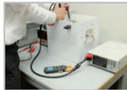
オンリースタイルのリチウムイオンバッテリーで使用しているセルは蓄電池大国中国のセルを使っています。オンリースタイルでは輸入したセルをそのまま使うのではなく、全てのセルを検品を行い、電圧、内部抵抗に問題が無いかを厳しくチェックした上で問題のないセルだけを使って製品の組み立てを行っております。地味な作業ではありますが安全や品質を確保するためには重要な工程になります。オンリースタイルでは慎重に検品検査を行うことで品質の確保に努めております。
