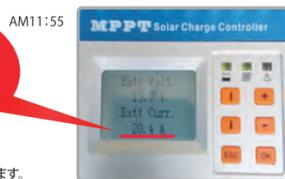
AM11:55 発電量:280W / 充電電流:20.4A / バッテリー電圧:13.7V
